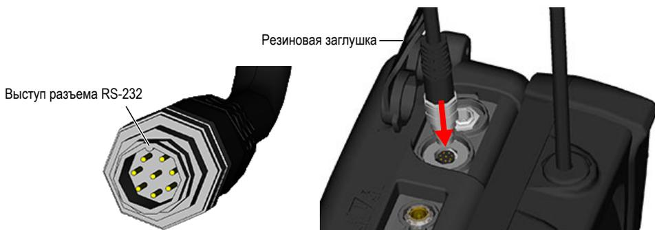
4. Повернув к себе адаптер 38-Link лицевой стороной, вращайте соединительную муфту разъема RS-232 по часовой стрелке до тех пор, пока резьба разъема не войдет в зацепление с резьбой порта.
