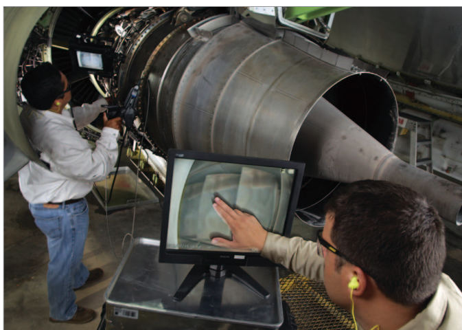
Одно и то же эндоскопическое изображение просматривается двумя операторами на внешнем мониторе VGA, подключенном к IPLEX RX для удаленного наблюдения
