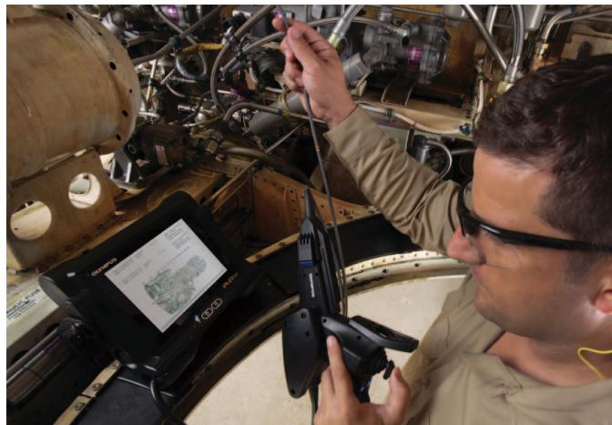
На мониторе IPLEX RX отображается руководство в формате PDF при выполнении эндоскопического контроля
