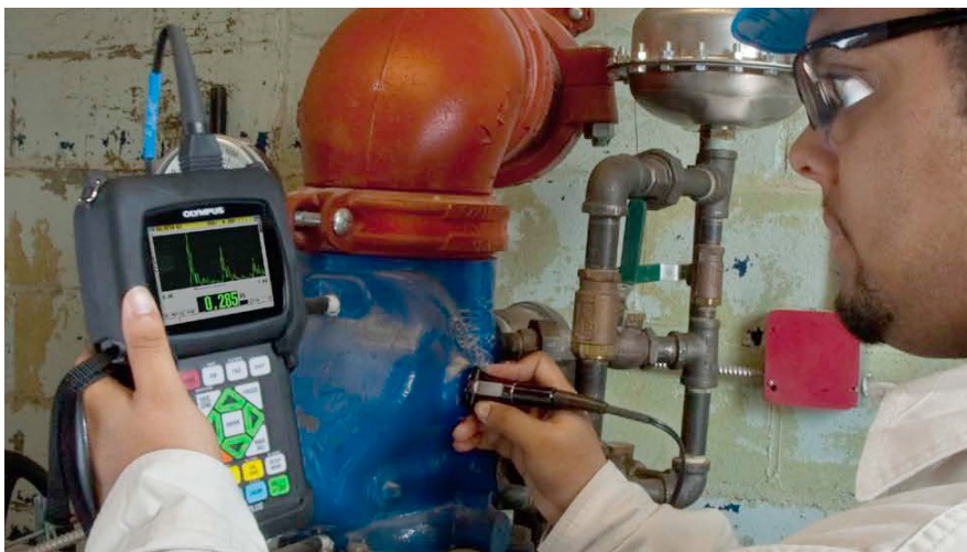
Рис. 1-1 Измерение толщины с помощью 38DL PLUS
