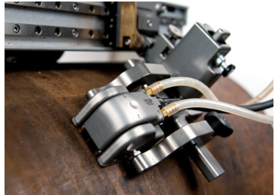
Автоматизированный контроль с использованием раздельно-совмещенного линейного ПФР и сканера MapROVER
