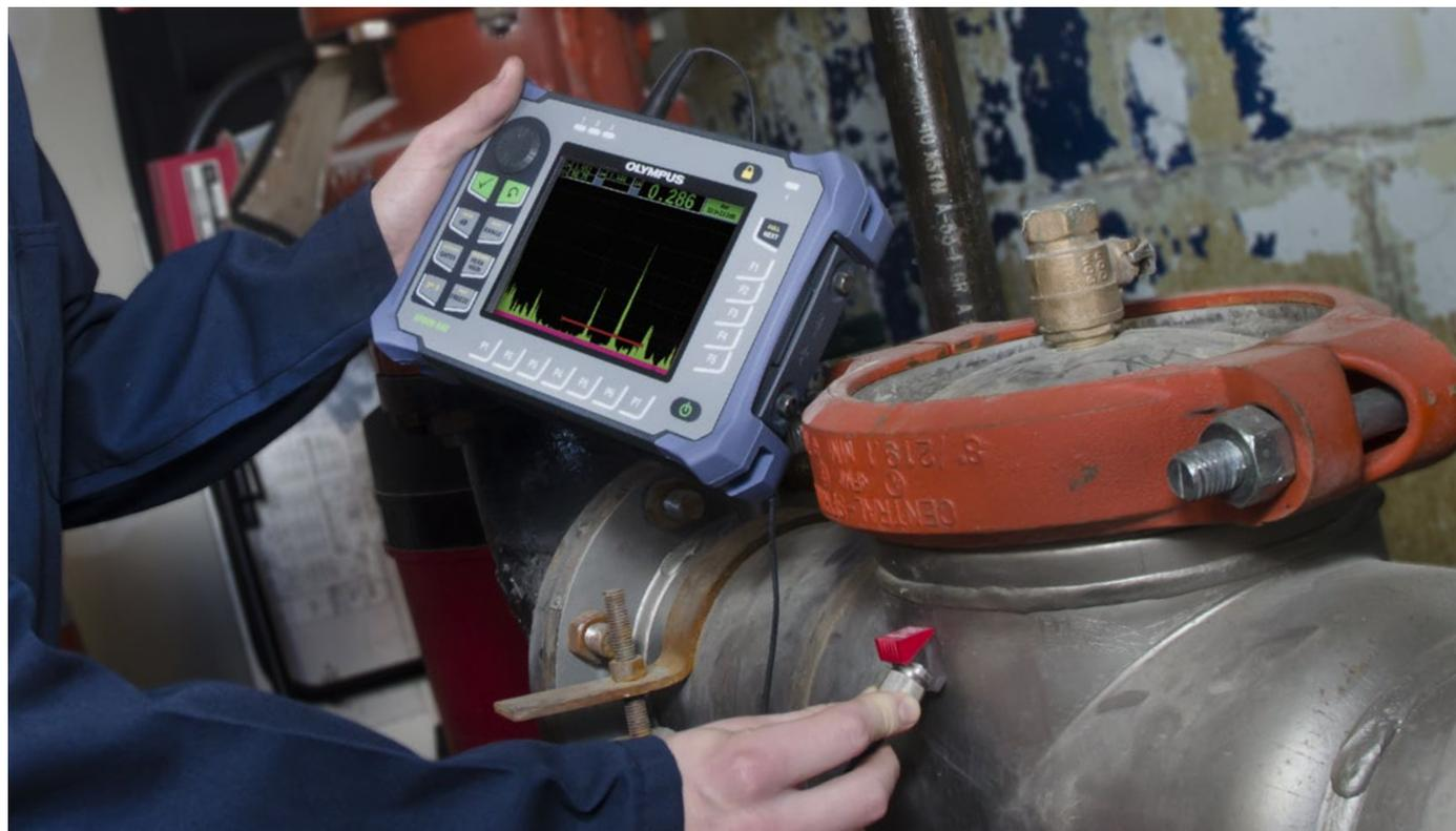
Ультразвуковой цифровой дефектоскоп EPOCH 650 оснащен всеми функциями стандартного портативного дефектоскопа Olympus и имеет интуитивно понятный интерфейс. Отлично организованное меню и клавиши быстрого доступа позволяют использовать все возможности высококачественной платформы.
