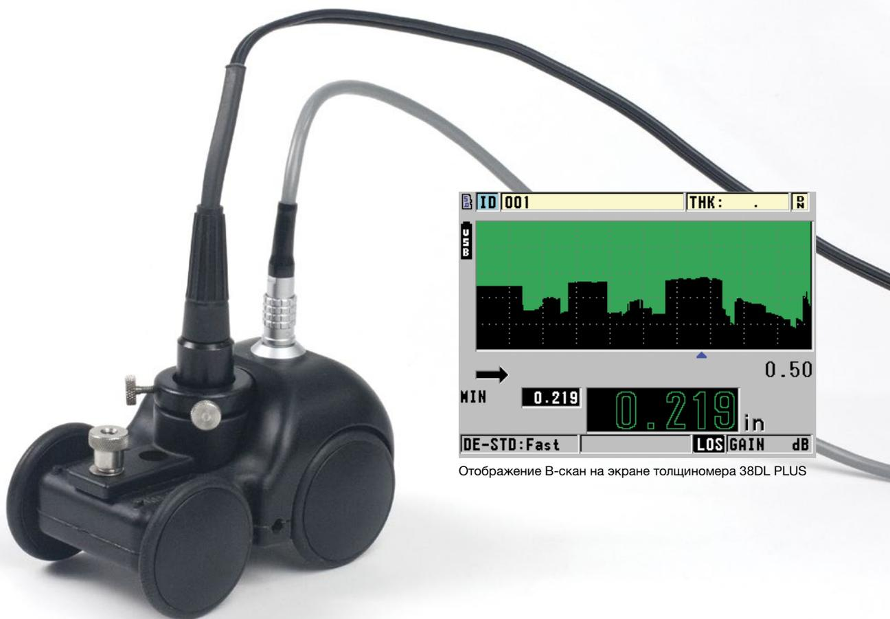
Отображение В-скан на экране толщиномера 38DL PLUS
