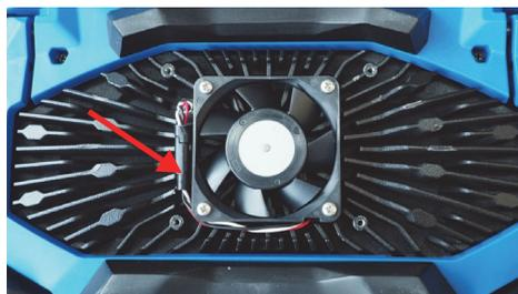
Рис. 4-3 Отсоединение (слева) и размещение кабеля вентилятора (справа)
