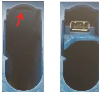
**Рис. 2-3** Скрытый разъем USB 2.0 (слева) в батарейном отсеке
