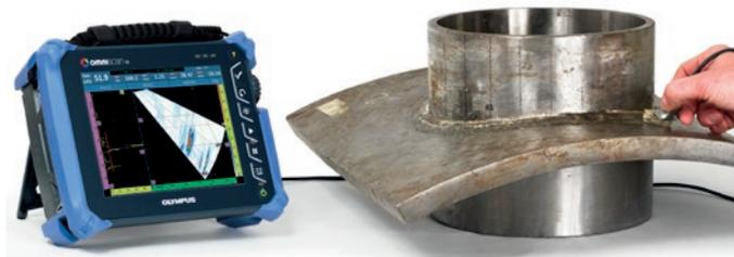
OmniScan PA является основным элементом в системе ручного и полу-автоматического контроля сварных швов, разработанной Olympus для нефтегазовой промышленности. Данная технология используется в соответствии с требованиями ASME, API и другими стандартами, отличается высокой скоростью обнаружения дефектов и простотой в интерпретации полученных данных.
