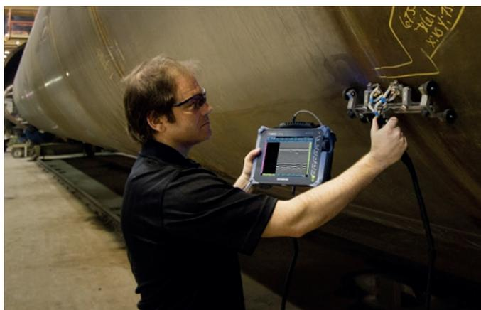
Технология TOFD - простой и эффективный метод для обнаружения дефектов сварных соединений. Высокая чувствительность метода TOFD существенно облегчает обнаружение дефектов и определение их размеров.
