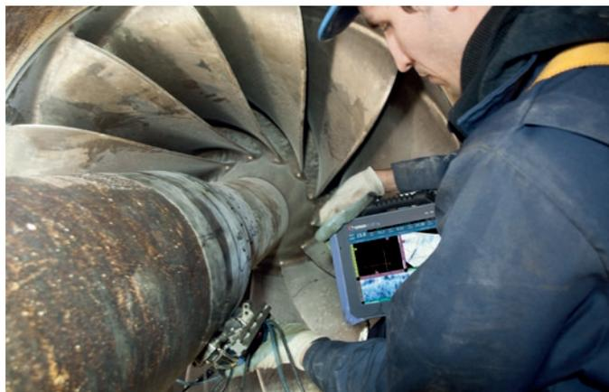
Ультразвуковые методы неразрушающего контроля позволяют выявлять трещины, утонения стенок труб и другие коррозионные повреждения. OmniScan SX предоставляет возможность проводить контроль продольными и поперечными волнами и является бюджетным решением для контроля качества материалов с использованием одной группы.
