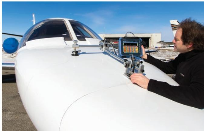
Контроль продольными волнами стал более доступен с прибором OmniScan SX. Olympus предлагает проверенное на практике решение для контроля расслоений в композитных материалах и оценки коррозионного утонения стенок.
