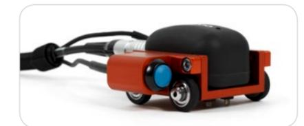
Технология C-скан Bond Testing (контроль качества клеевых соединений) требует использования специального адаптера.
