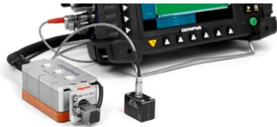
Возможность одновременного подключения преобразователей ECA и ECT обеспечивает непрерывность работы, без необходимости выключения прибора и реконфигурации настроек
