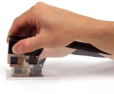
Генерация сигналов при отрыве ECA-преобразователя от поверхности происходит так же, как с использованием ECT-преобразователя.
