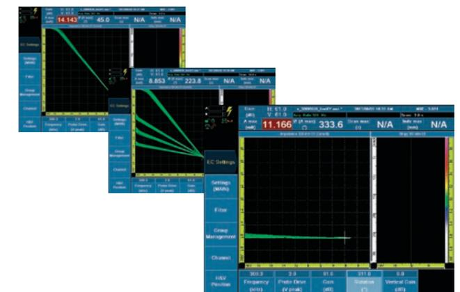
Настройка фазового угла в режиме реального времени с помощью ручки регулятора OmniScan. Подобным образом настраиваются параметры усиления, вертикальное усиление и нулевая точка (Г/В).
