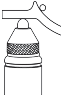
Рис. 4-15 Неправильное измерение. Шарик заблокирован
