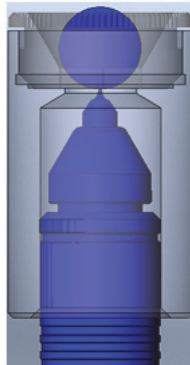
Рис. 4-7 Выравнивание диска на заостренном колпачке ПЭП
