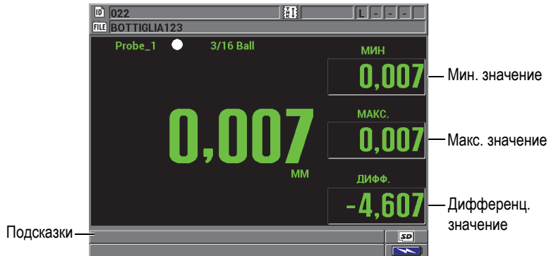
Рис. 2-2 Дополнительные значения, отображаемые на экране измерений
