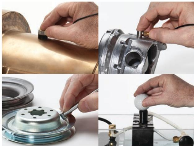
Ультразвуковой контроль толщины отличается точностью, надежностью и высокой повторяемостью. Контроль выполняется при одностороннем доступе к изделию, без необходимости демонтажа или разрушения.
