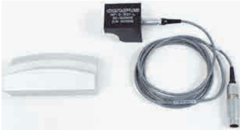
Рис. 5-52 Необходимые материалы для контроля авиационных колес
