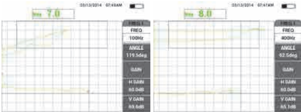
Рис. 5-29 Калибровка с использованием слишком низкой частоты (слева) или слишком высокой частоты (справа)
