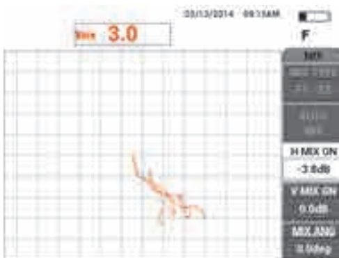
Рис. 5-108 Настройка значения H MIX GN
