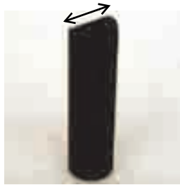
Рис. 5-32 Длинная сторона наконечника ПЭП
