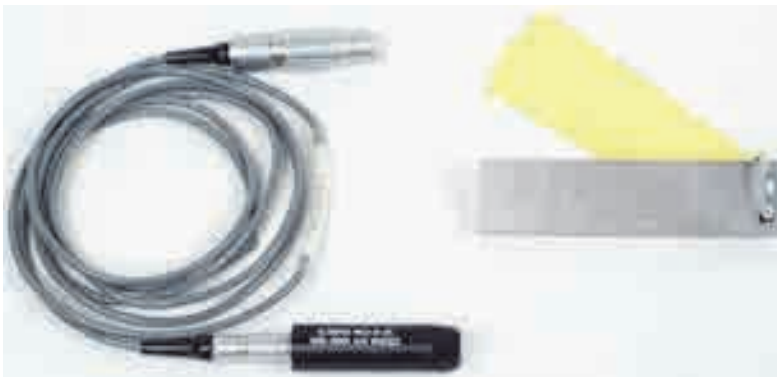
Рис. 5-30 Необходимые компоненты для контроля сварных швов изделий из ферромагнитных материалов
