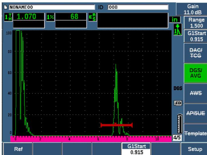
Рис. 11-15 Сигнал от контрольного отражателя перед фиксацией
