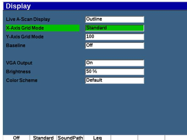
Рис. 6-3 Выбор режима отображения сетки по оси X
