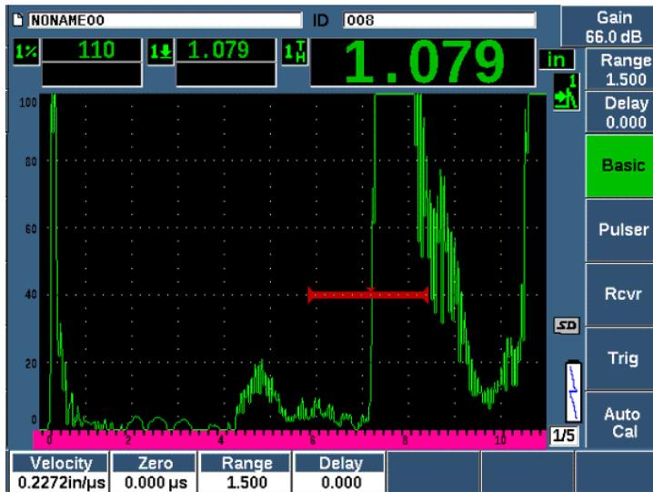
Рис. 9-12 Пример стробированного сигнала для калибровки скорости
