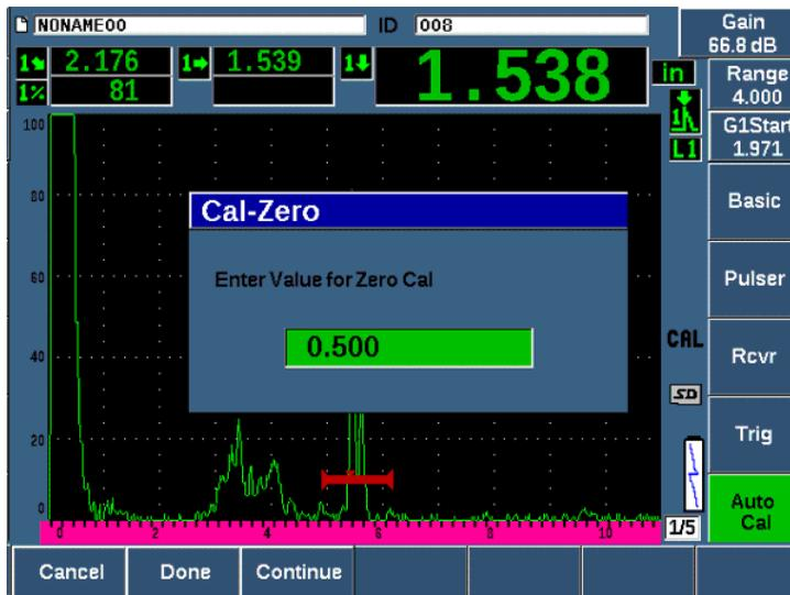
Рис. 9-27 Ввод значения толщины для калибровки нуля
