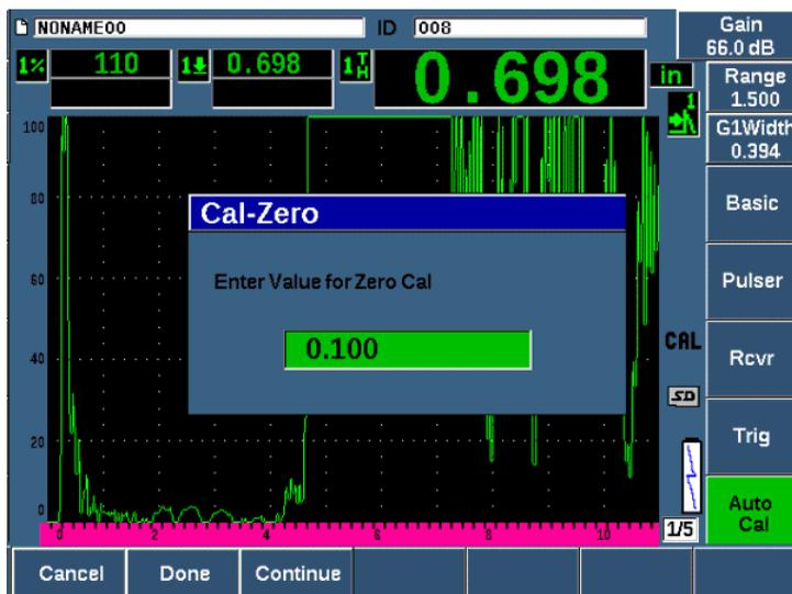
Рис. 9-11 Ввод значения толщины для калибровки нуля
