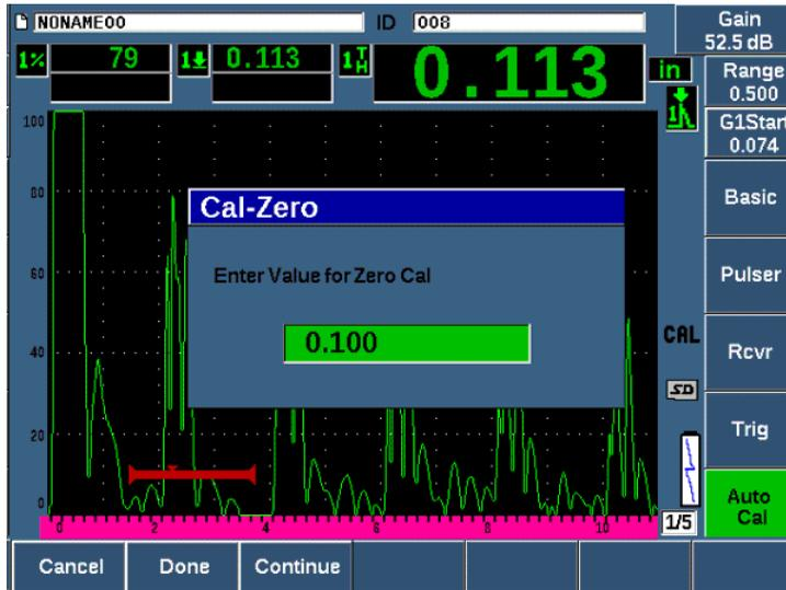
Рис. 9-7 Ввод значения толщины для калибровки нуля
