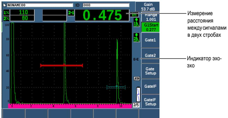
Рис. 7-7 Пример измерения эхо-эхо
