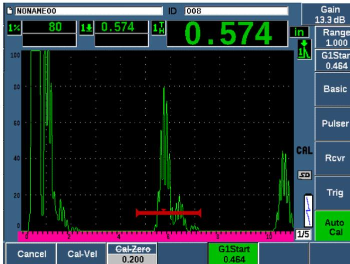
Рис. 9-3 Пример стробированного сигнала для калибровки скорости
