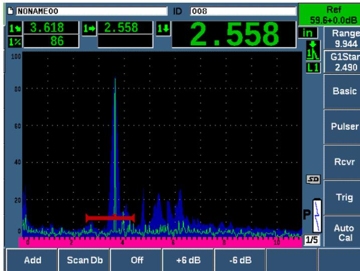
Рис. 9-25 Настройка опорного усиления
