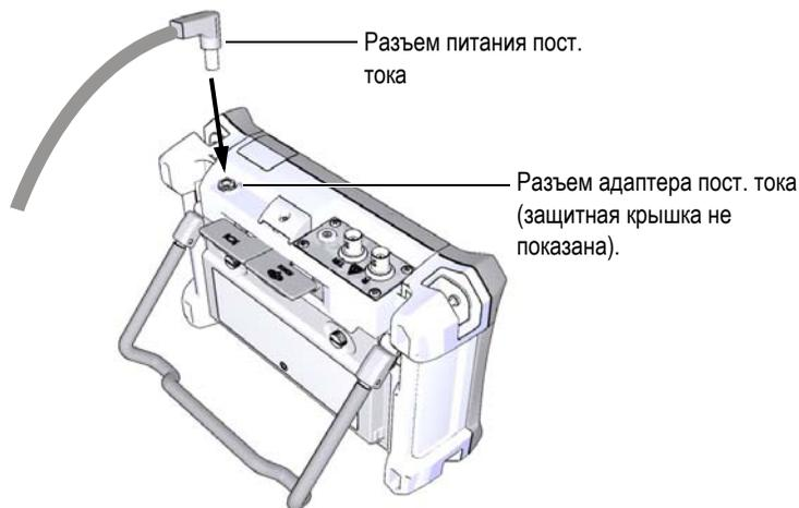
**Рис. 2-3 Подключение к разъему питания пост. тока**
