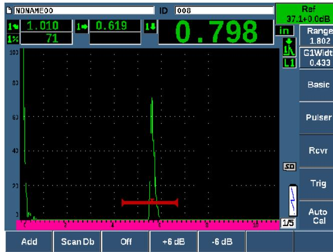
Рис. 3-18 Настройка опорного усиления
