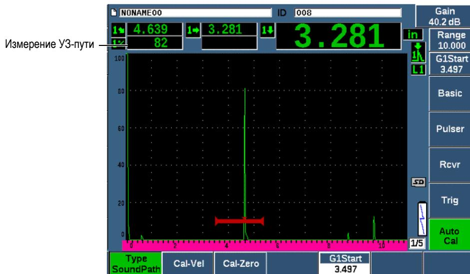
Рис. 9-20 Пример стробированного сигнала для калибровки нуля
