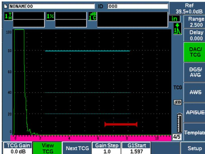
Рис. 11-7 Построенные кривые DAC в режиме просмотра ВРЧ
