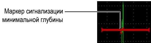
Рис. 7-9 Маркер сигнализации минимальной глубины
