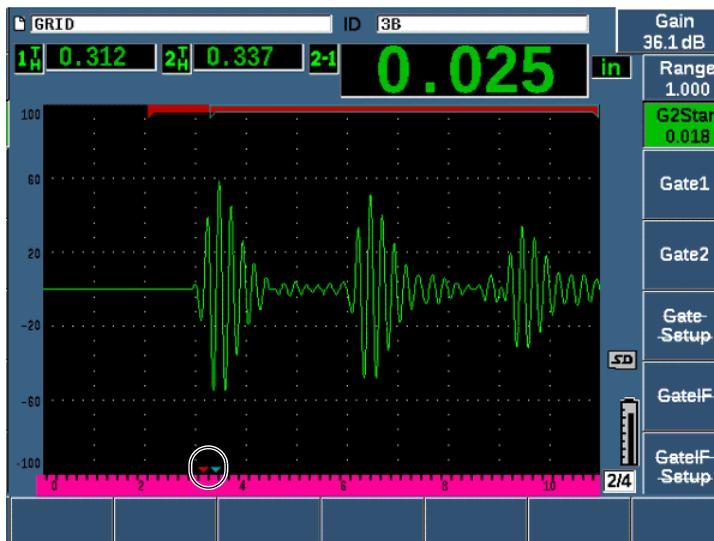
Рис. 11-42 Измерения эхо-эхо в коррозионном модуле
