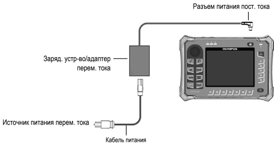
**Рис. 2-2 Подключение зарядного устройства/адаптера**
