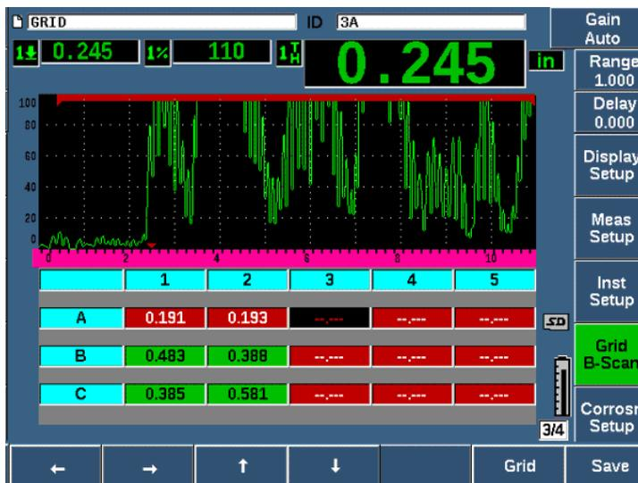
Рис. 11-37 Коррозионный модуль – Вид сетки
