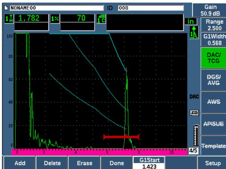
Рис. 11-5 Незавершенная DAC, где все эхо-сигналы установлены на 80% высоты экрана
