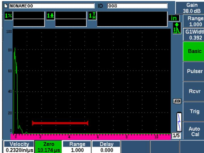
Рис. 9-5 Настройка смещения нуля для первого эхо-сигнала линии задержки
