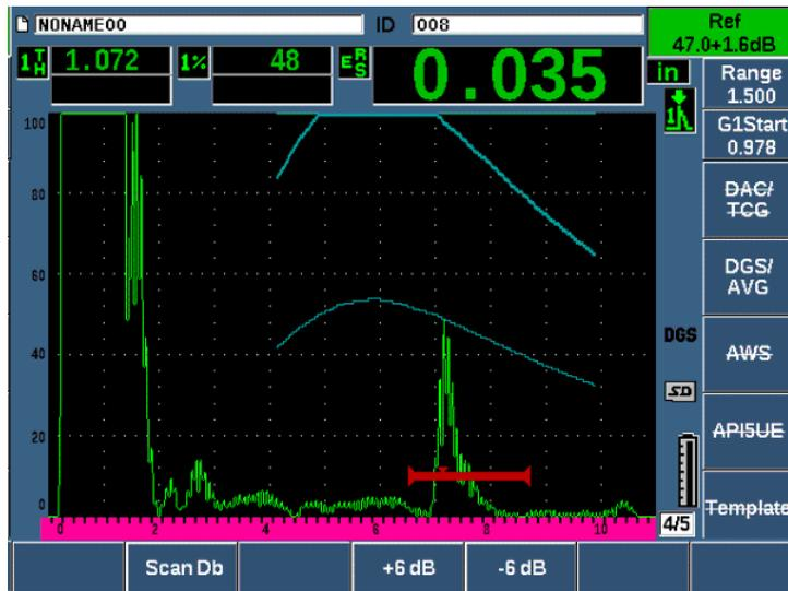
Рис. 11-17 Отрегулированное усиление кривой АРД-диаграммы
