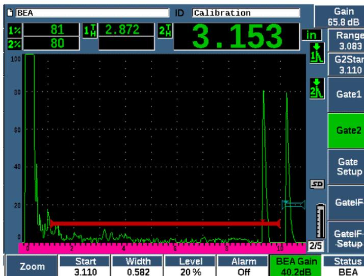
Рис. 11-32 Настройка усиления донного эхо-сигнала
