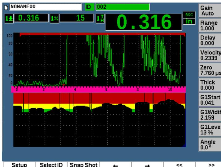
Рис. 11-47 Отображение В-скан в регистраторе данных
