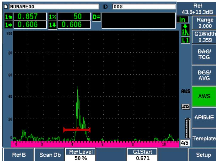
Рис. 11-19 опорное значение В до сохранения
