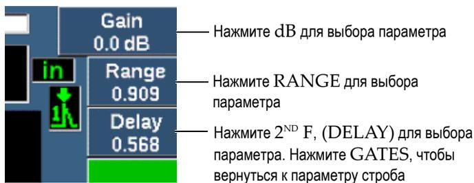
Рис. 4-5 Примеры параметров прямого доступа **Gain** (Усил.), **Range** (Диапазон) и **Delay** (Задержка)
