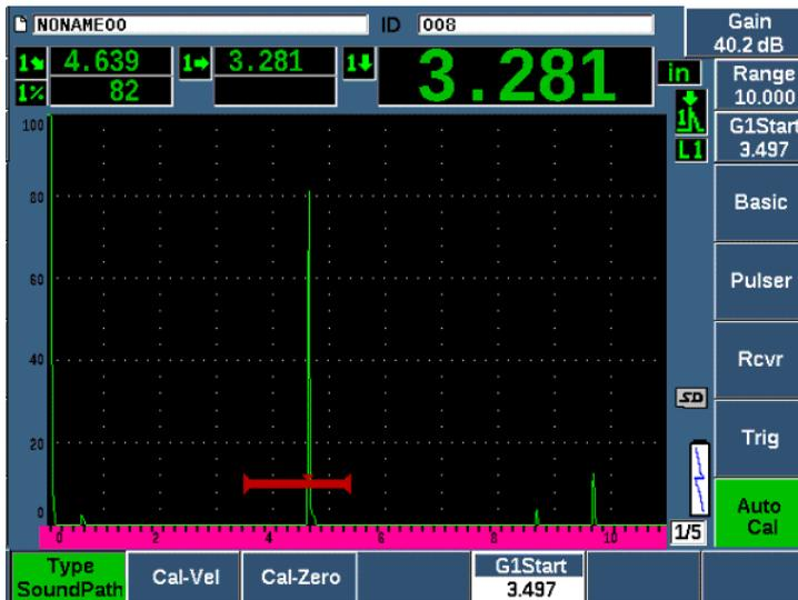
Рис. 9-22 Пример стробированного сигнала для калибровки скорости
