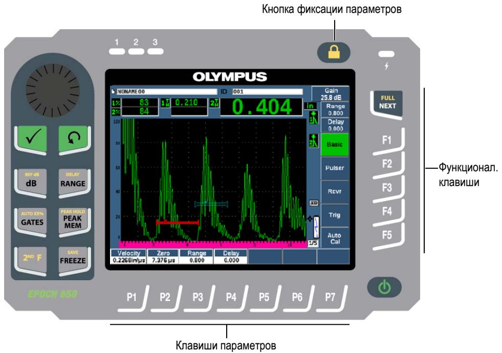
Рис. 1-12 Клавиши параметров и функций
