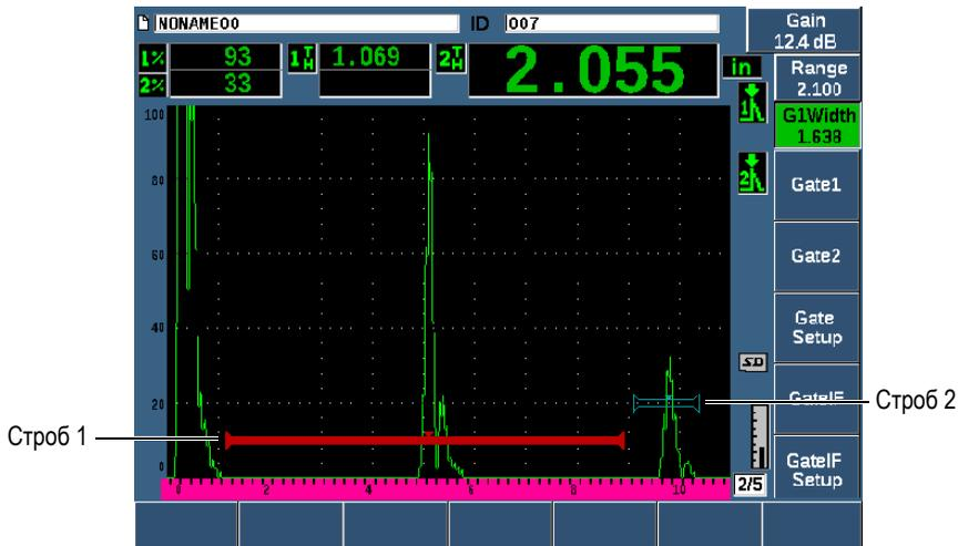
Рис. 4-8 Пример отображения А-скана со стробами
