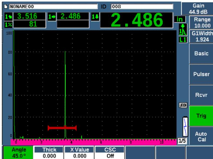
Рис. 9-19 Проверка угла ввода луча
