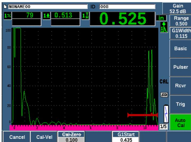
Рис. 9-8 Пример стробированного сигнала для калибровки скорости
