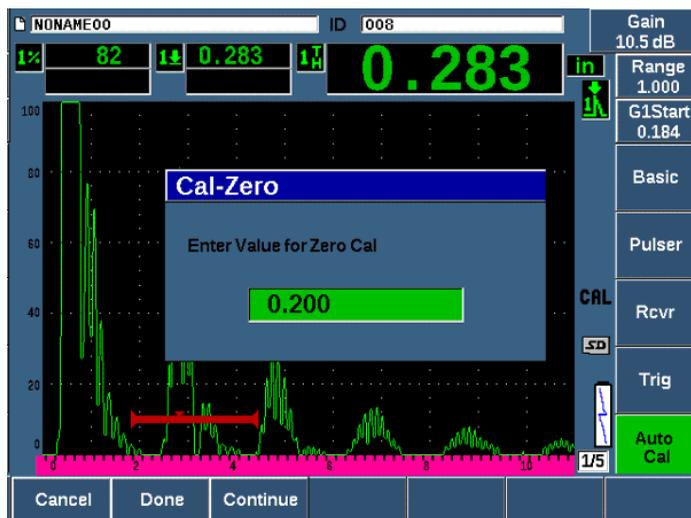
Рис. 9-2 Ввод значения толщины Zero Cal
