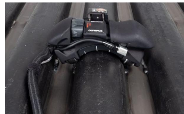
Сканер FlexoFORM также используется для продольного сканирования труб. Данная конфигурация используется, в частности, для контроля труб малого диаметра, или если зона интереса сконцентрирована в определенном месте на поверхности трубы. В таких ситуациях, лучше выполнять контроль по продольной оси трубы, вместо сканирования по окружности с плоским ФР-преобразователем. Сканер FlexoFORM может также использоваться для контроля стенок в электрических бойлерах.
