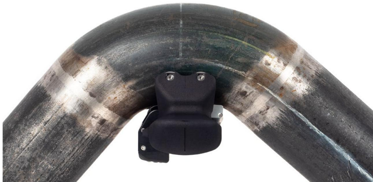
Сканер FlexoFORM – Контроль интрадосагиба трубы 101,6 мм НД.
