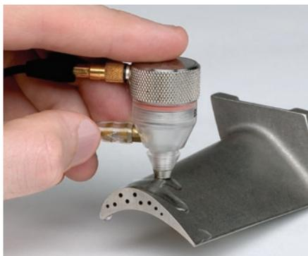
Модель 35 с датчиком с линией задержки или при использовании иммерсионного метода может проводить точные измерения как на вогнутых («корыто»), так и на выпуклых («спинна») поверхностях лопаток турбины.
