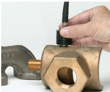
Модель 35HP используется для измерений цилиндрических расточных деталей и прочих деталей из литого металла или материалов с высоким коэффициентом затухания звука.
