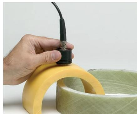
Приборы 35HP прекрасно подходят для измерения толщины стекловолоконна и композитов, применяемых в аэрокосмических изделиях, при производстве корпусов судов и резервуаров.
