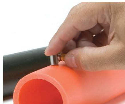
Пластиковые или металлические трубы разных диаметров легко измеряются при помощи ультразвукового контактного преобразователя. При измерении объектов с малым диаметром может потребоваться иммерсионный метод измерения.
