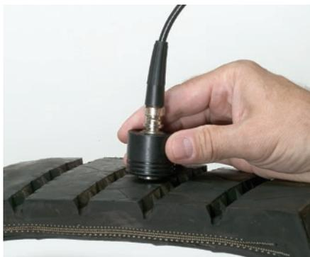
Измерение глубины залегания стального/плетёного корда в резиновых конвейерных лентах и автомобильных покрышках.
