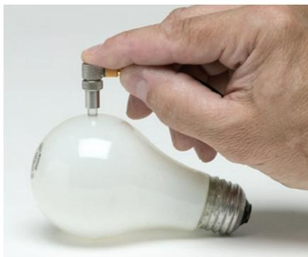
В этом классическом случае микрометр не подойдёт. Зато модель 35 с преобразователем M208 произведёт все необходимые измерения с точностью до 0,001 мм без разбивания стекла.
