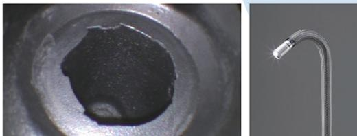
Исследуйте дефекты, такие как неровности и трещины, в местах, которые невозможно увидеть снаружи. В видеоскопе Series C применены передовые оптические и измерительные технологии Olympus. Для получения снимков требуемой яркости используются 8 уровней регулировки яркости, технология подавления бликов, яркая светодиодная подсветка и чувствительная ПЗС-матрица.
