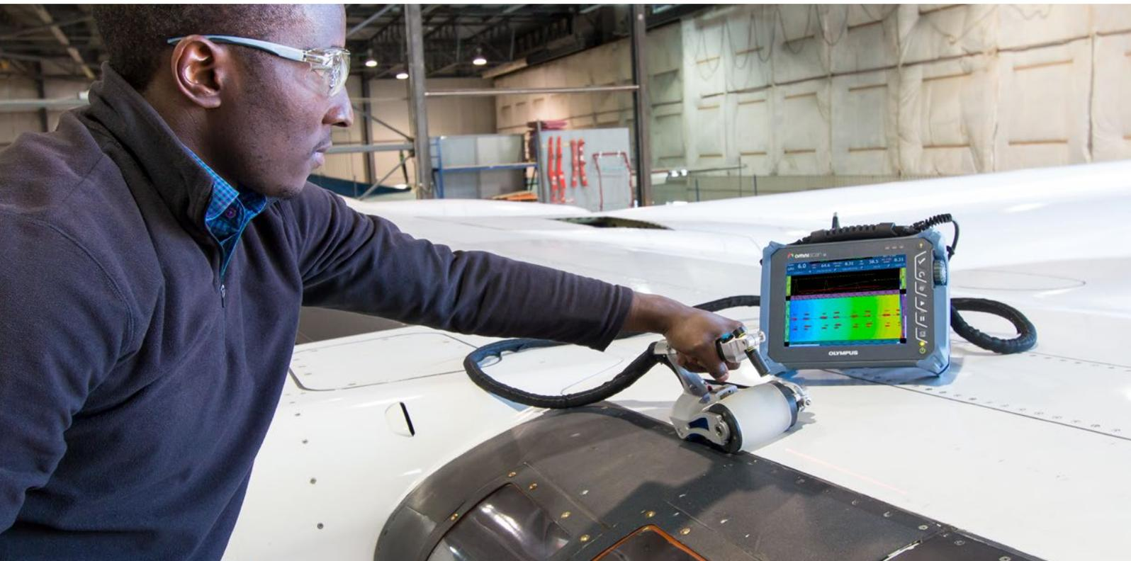
RollerFORM™ от Olympus предназначен для контроля композиционных и других материалов с гладкой ровной поверхностью. RollerFORM — это не только доступная замена двумерным системам кодирования, но и прекрасная альтернатива иммерсионным методам контроля.
