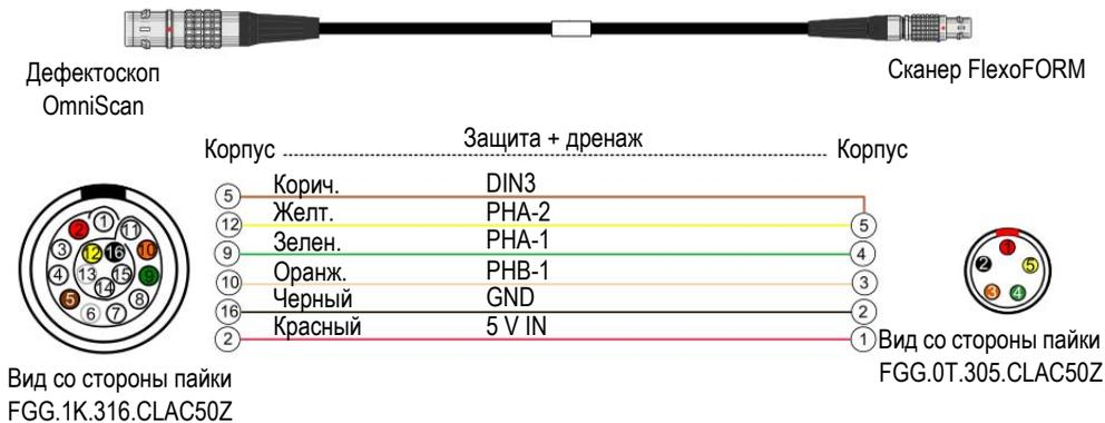
Рис. 6-1 Расположение выводов разъема LEMO (5–16 контактов)
