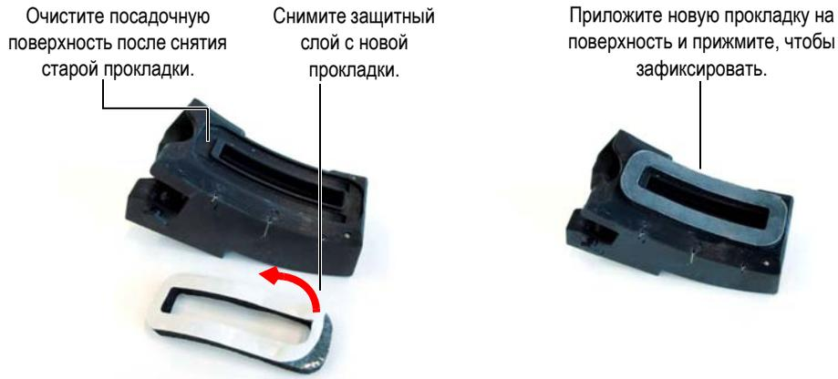
**Рис. 5-3 Замена уплотнительной прокладки**
