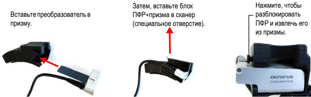
Рис. 2-3 Установка преобразователя и призмы
