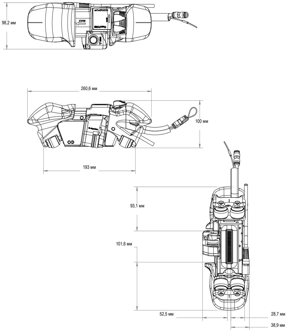
Рис. 6-2 Габариты сканера
