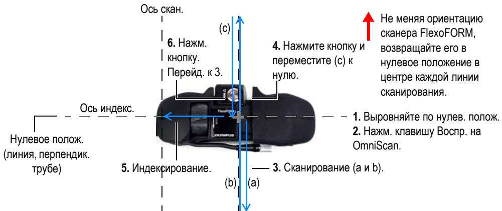
Рис. 4-3 Схема сканирования для колена трубы
