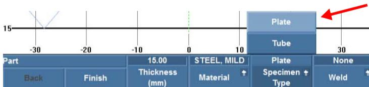
Рис. 2-1 Выбор Пластины в поле Тип образца
