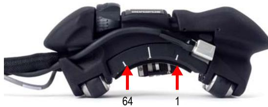
**Рис. 4-4** Отметки элементов ПЭП на призме
