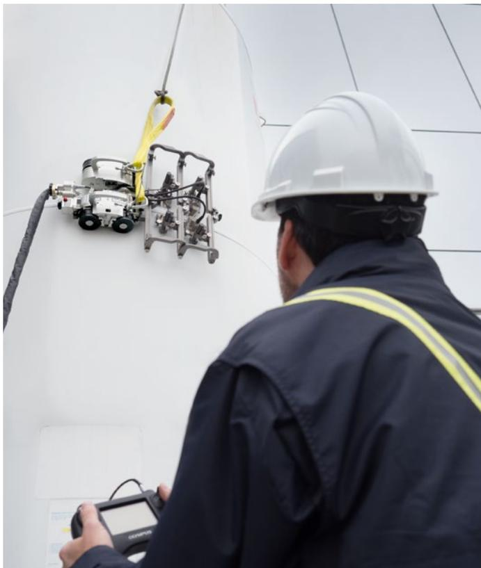
Портативный моторизованный сканер SteerROVER™ разработан на базе уже проверенного на практике сканера MapROVER™ и является дистанционно управляемым. Крупные объекты из ферромагнитных материалов (н-р, сосуды и резервуары высокого давления), труднодоступные для контроля, больше не представляют сложности. Сканер может быть оснащен моторизованным растровым рычагом для коррозионного мониторинга, или держателем ПЭП – для контроля сварных соединений.
