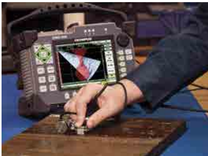
S-скан с отображением профиля сварного шва
