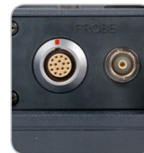
16-контактный разъем LEMO поддерживает технологию NORTEC POWERLINK® с функцией автоматического распознавания преобразователя и загрузки предустановленных настроек прибора для быстрой конфигурации.
