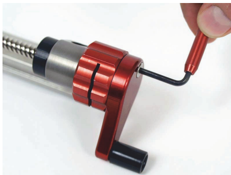
Рис. А-5 Установка рукоятки на конце рамы
