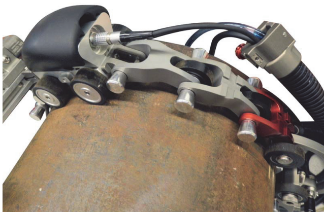
Рис. А-13 Подключение разъема LEMO гофрированного кабеля к основному модулю ChainSCANNER
