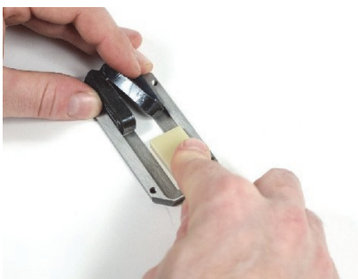
Рис. 1-7 Снятие старого слоя поролона
