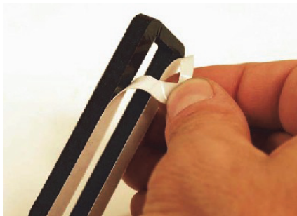
Рис. 1-8 Снятие защитного слоя с новой поролоновой прокладки
