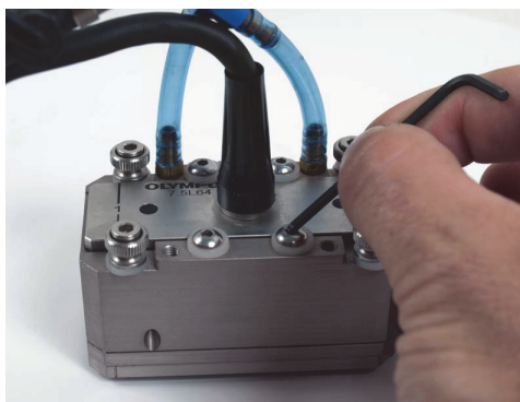
Рис. 3-1 Извлечение крепежных винтов
