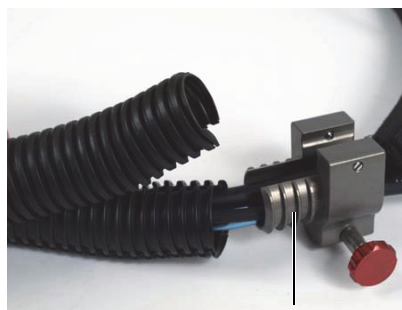
Резьбовая часть зажима
