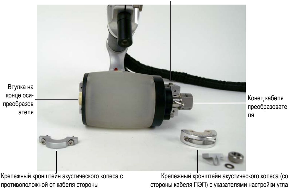
Рис. 6-36 Установка крепежных кронштейнов акустического колеса
