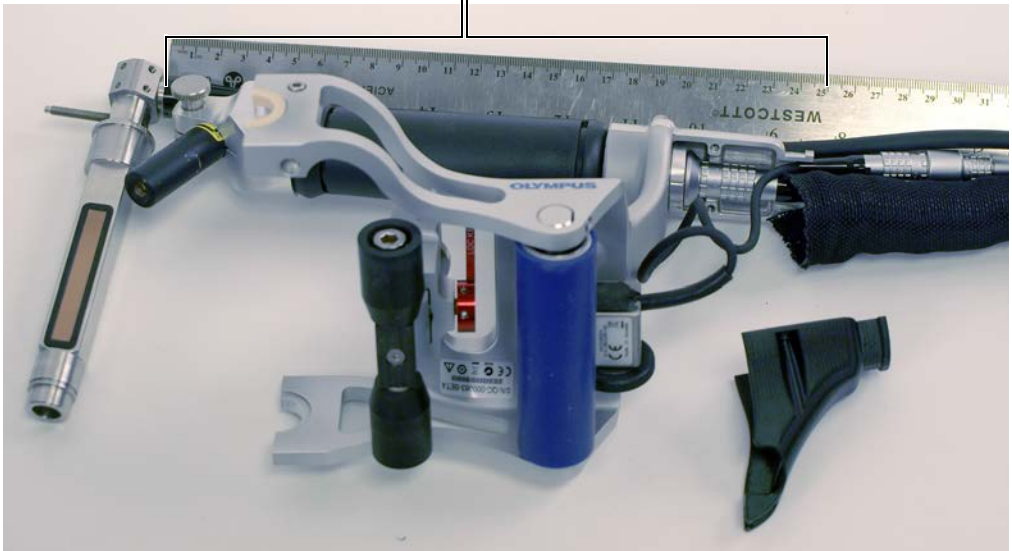
Рис. 6-13 Кабель преобразователя, протянутый вдоль рукоятки RollerFORM
