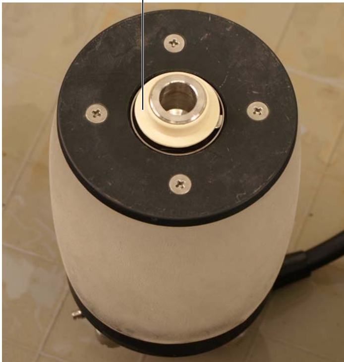
Рис. 6-35 Установка втулки на конце оси-преобразователя
