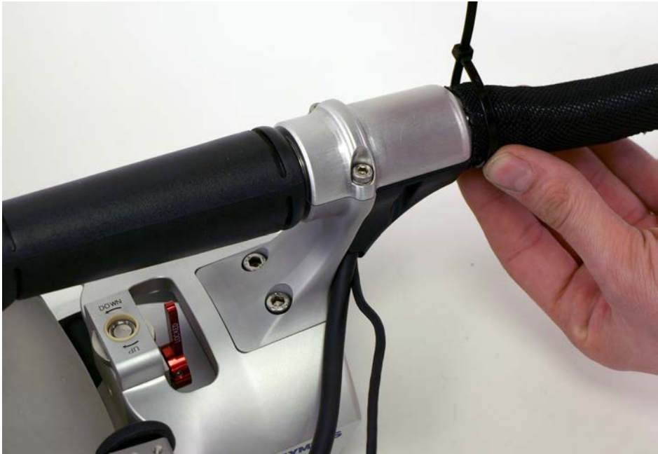
Рис. 6-51 Установка оболочки кабеля и кабельной стяжки
