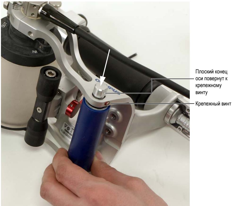
Рис. 6-57 Выравнивание плоской части конца оси ролика с крепежным винтом
