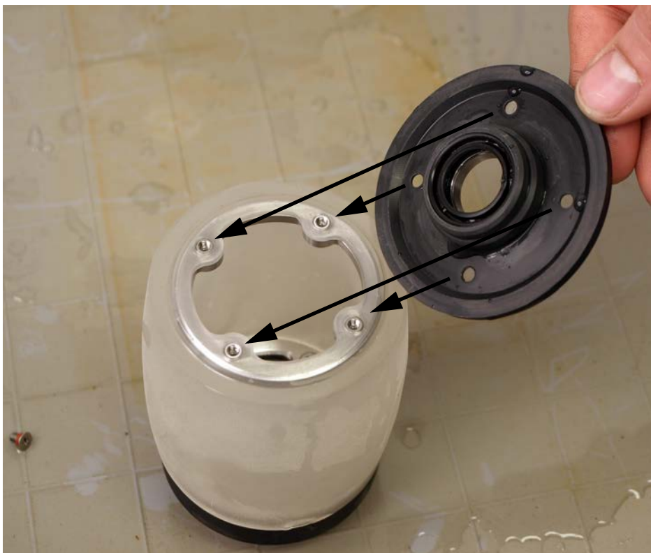
Рис. 6-33 Установка плоского фланца
