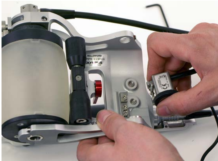
Рис. 6-44 Снятие кодировщика Mini-Wheel
