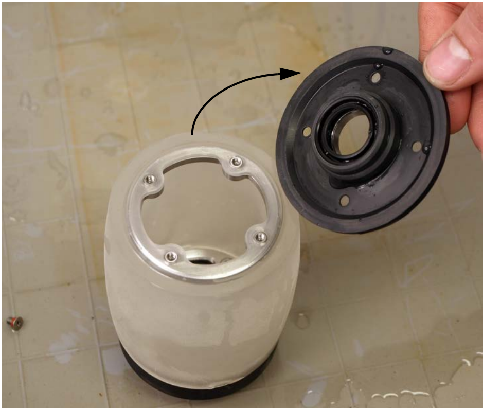
Рис. 6-25 Снятие плоского фланца акустического колеса
