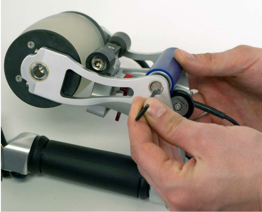
Рис. 6-53 Извлечение оси заднего ролика из гнезда
