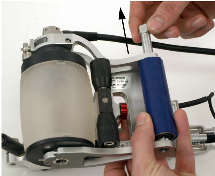
Рис. 6-54 Извлечение оси заднего ролика
