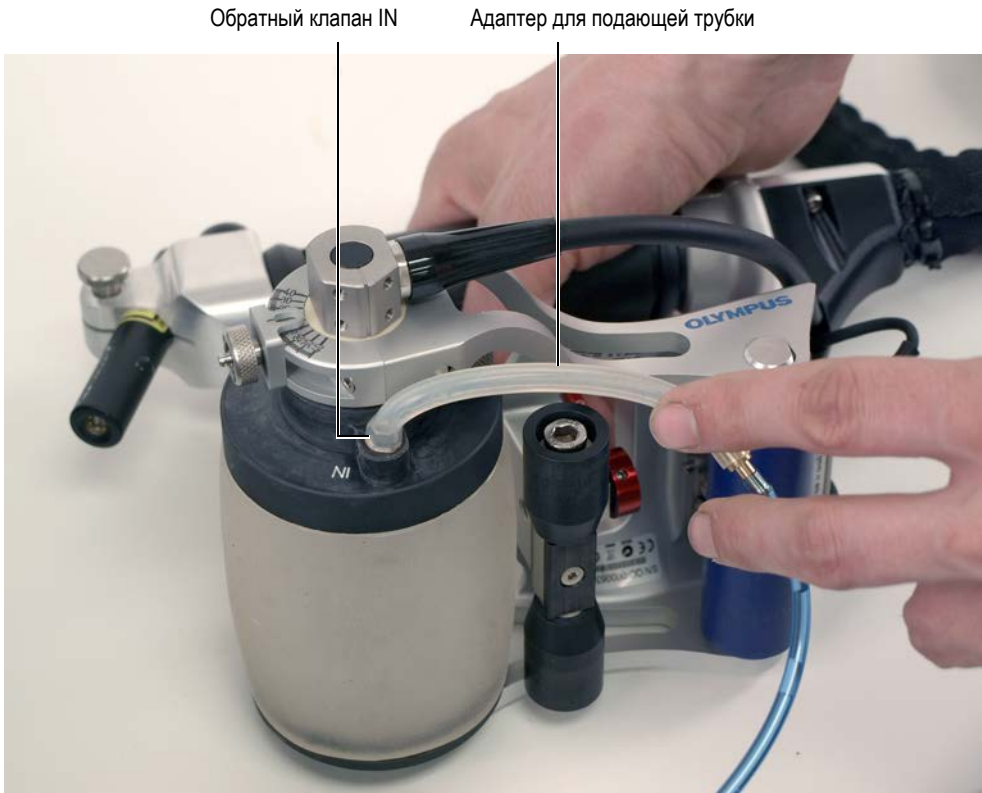
Рис. 3-2 Подключение адаптера подающей трубки к обратному клапану IN
