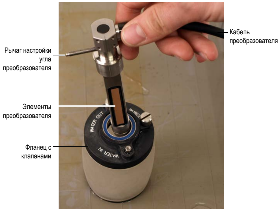
Рис. 6-9 Установка оси-преобразователя в акустическое колесо
