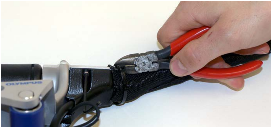
Рис. 6-38 Разрезание кабельной стяжки на рукоятке RollerFORM
