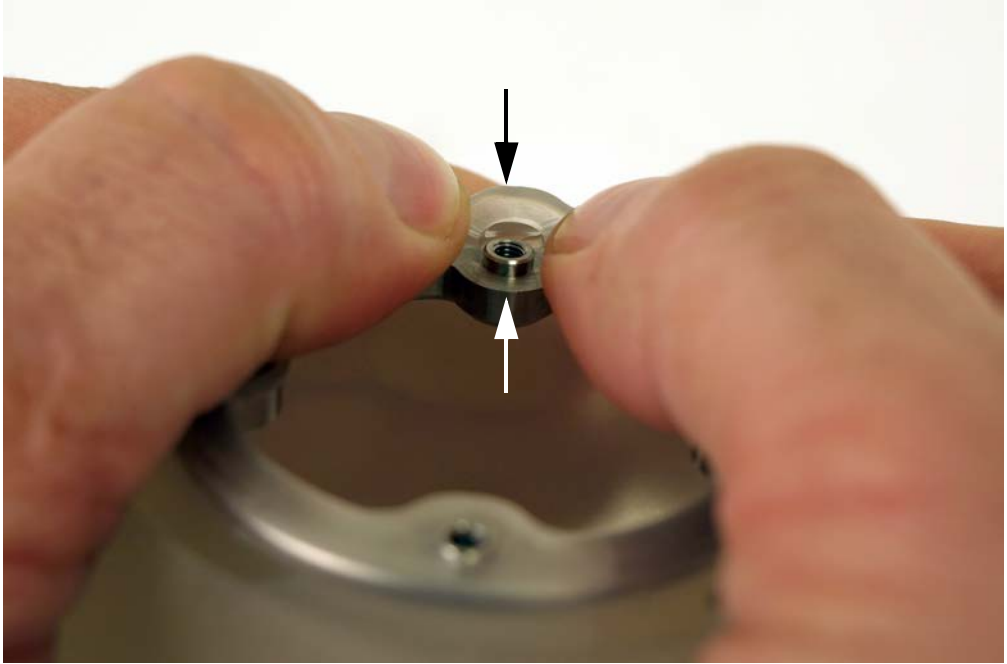
Рис. 6-30 Установка кольца в гнездо шины
