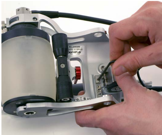
Рис. 6-55 Ослабление крепежного винта кодировщика
