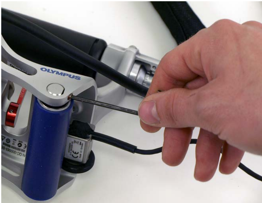
Рис. 6-40 Ослабление крепежного винта заднего ролика
