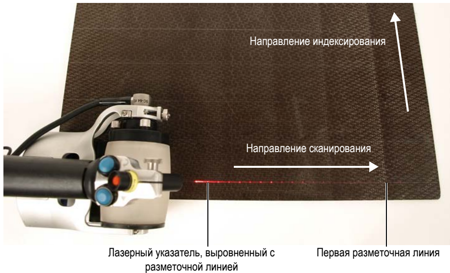
Рис. 5-4 Расположение RollerFORM по первой разметочной линии
