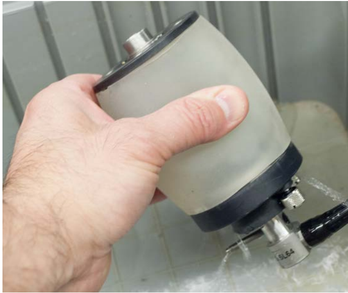
Рис. 6-5 Опорожнение резервуара колеса
