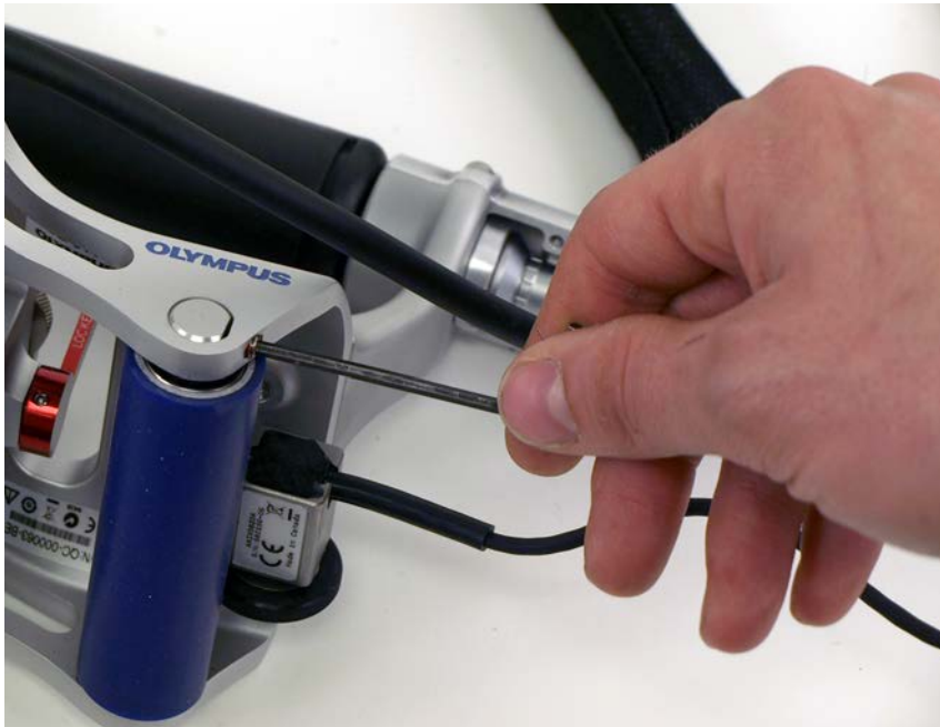
Рис. 6-52 Ослабление крепежного винта заднего ролика
