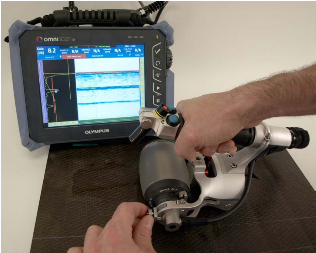
Рис. 4-1 Настройка угла преобразователя для оптимизации сигнала
