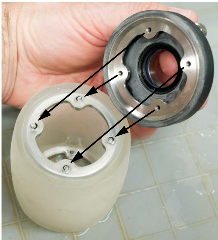
Рис. 6-31 Установка фланца с контрольными клапанами
