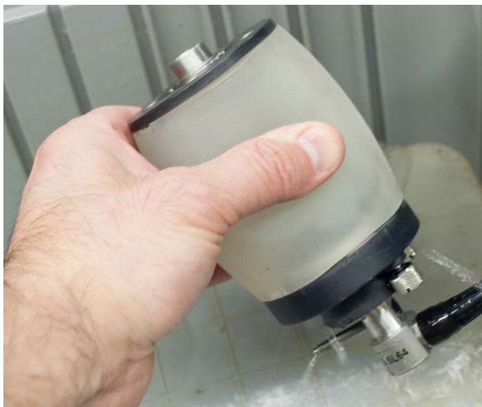
Рис. 6-18 Опорожнение резервуара колеса
