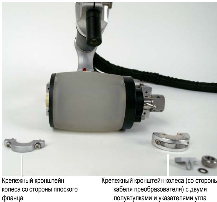
Рис. 6-2 Демонтаж крепежных кронштейнов акустического колеса
