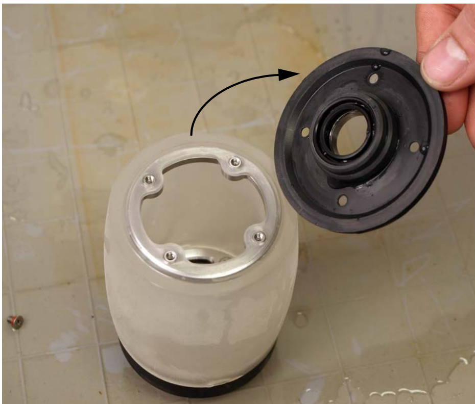
Рис. 6-20 Снятие плоского фланца акустического колеса
