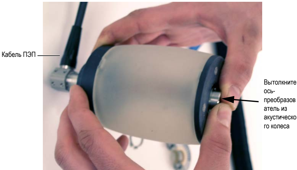
Рис. 6-8 Извлечение оси-преобразователя из акустического колеса
