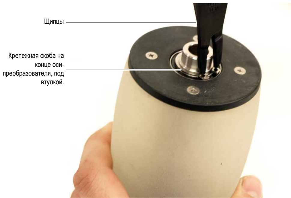
Рис. 6-7 Снятие крепежной скобы с наконечника оси-преобразователя
