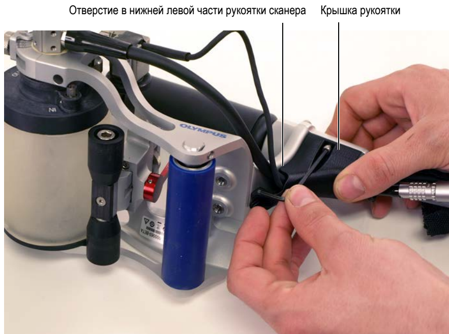
Рис. 6-50 Установка крышки на рукоятке сканера RollerFORM
