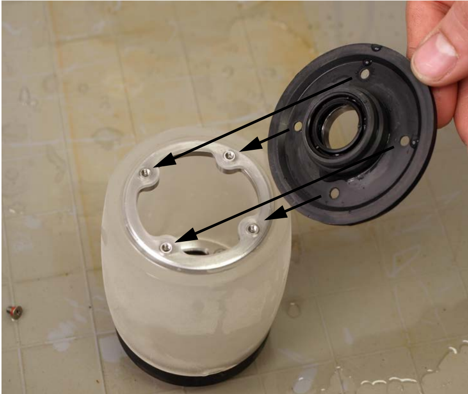
Рис. 6-21 Установка плоского фланца
