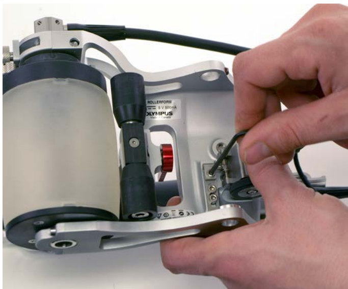
Рис. 6-43 Ослабление крепежного винта кодировщика
