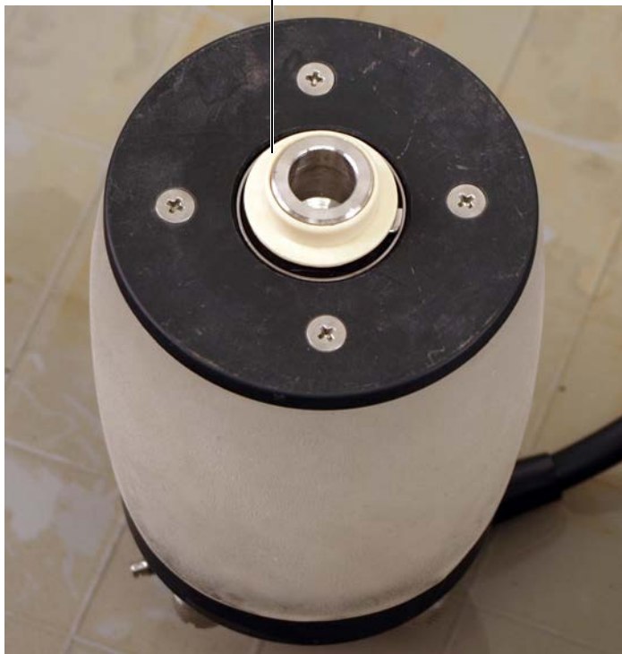
Рис. 6-6 Снятие втулки с оси-преобразователя
