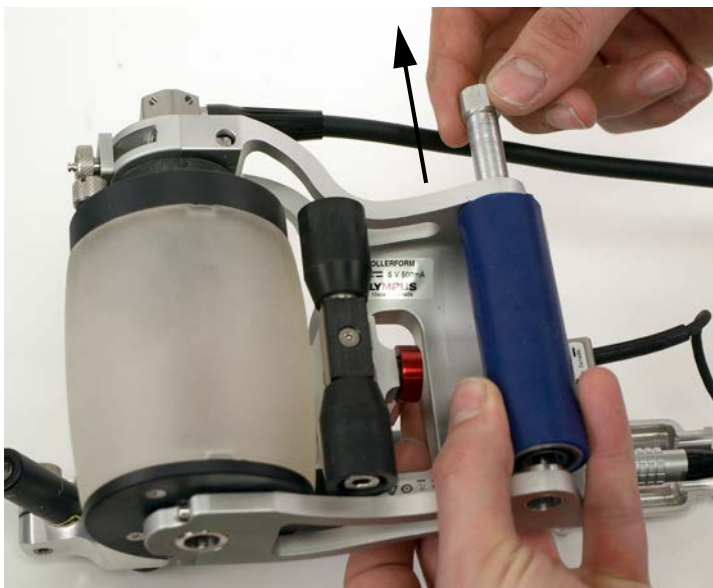
Рис. 6-42 Извлечение оси заднего ролика
