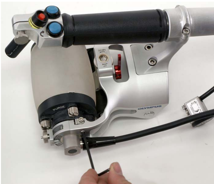
Рис. 6-47 Ослабление винта альтернативного держателя кодировщика
