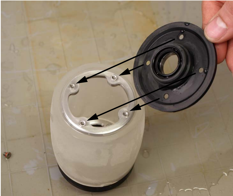
Рис. 6-16 Установка плоского фланца
