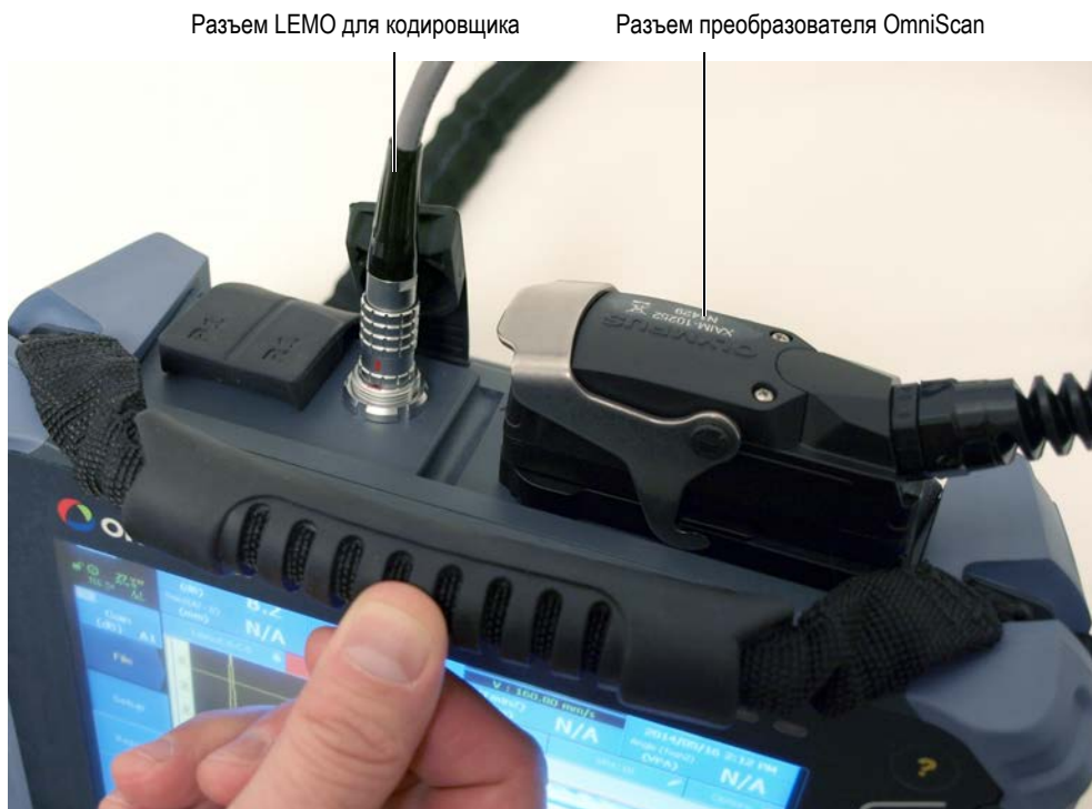
Рис. 2-1 Прибор OmniScan с подключенными кабелями RollerFORM
