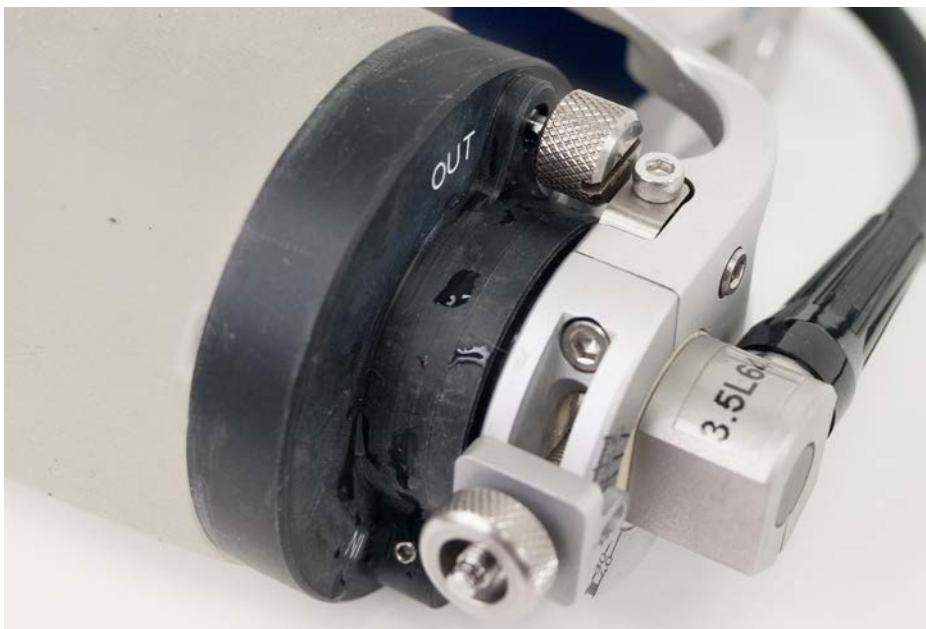
Рис. 6-4 Расположение клапана OUT
