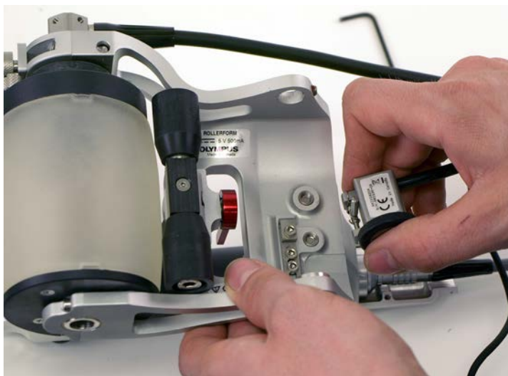
Рис. 6-56 Снятие кодировщика Mini-Wheel
