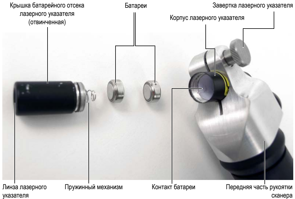
Рис. 6-61 Замена батарей лазерного указателя
