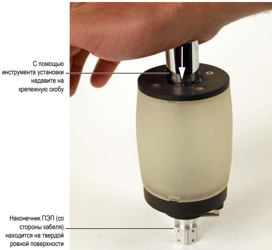
Рис. 6-11 Установка крепежной скобы на наконечник оси-преобразователя
