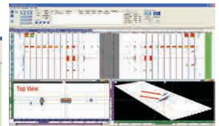
Секторное сканирование с наложением сварного шва [отображает угол и кончик риски (длиной 3 мм)].
