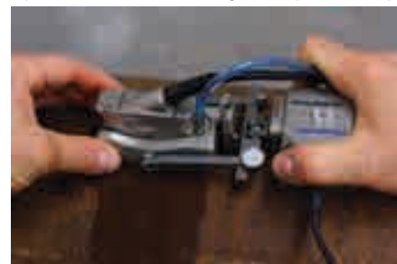
Сканер VersaMOUSE и RexoFORM – Коррозионный мониторинг
