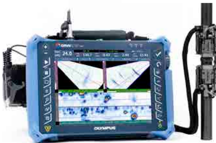
Сканер COBRA на трубе диам. 21 мм с двумя ПФР A15 и OmniScan MX2 16:64. Экран OmniScan отображает две группы ФР (РА) с секторными сканами и С-сканами.
