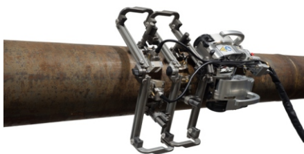
Сканер SteerROVER с держателем ПЭП – контроль продольных сварных швов.
