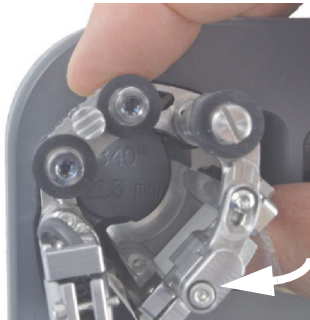
Рис. 2-17 Настройка положения держателя ПЭП для НД менее 33,4 мм
