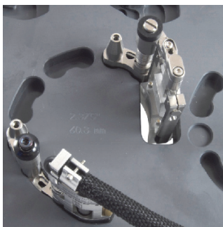
Рис. 2-13 Установка держателя ПЭП в шаблон настройки
