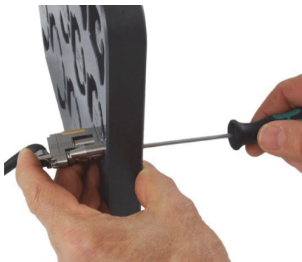
Рис. 2-9 Затяните регулировочный винт хвоста
