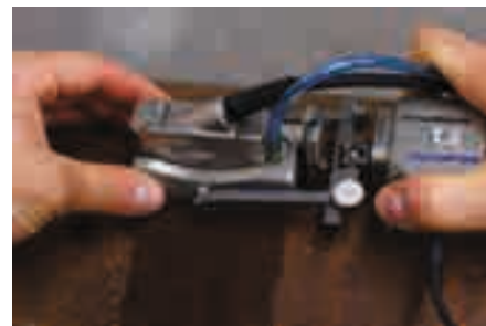
Сканеры VersaMOUSE и REXOFORM для коррозионного мониторинга
