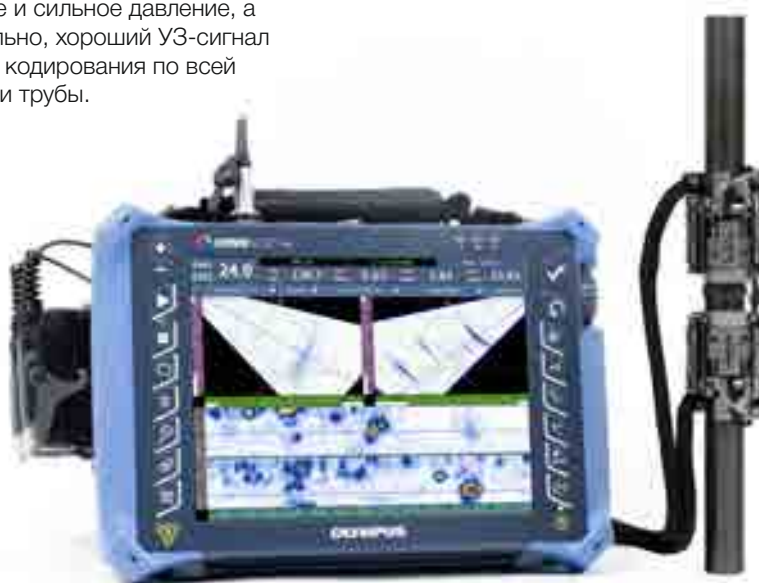
Сканер COBRA, установленный на трубе диам. 21 мм с двумя ФР-ПЭП A15, и дефектоскоп OmniScan® MX2 16:64. На экране OmniScan отображается две группы ФР (РА) с секторными сканами и С-сканами.
