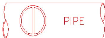
Рис. 10-1 Выравнивание ПЭП перпендикулярно к центральной оси трубы
